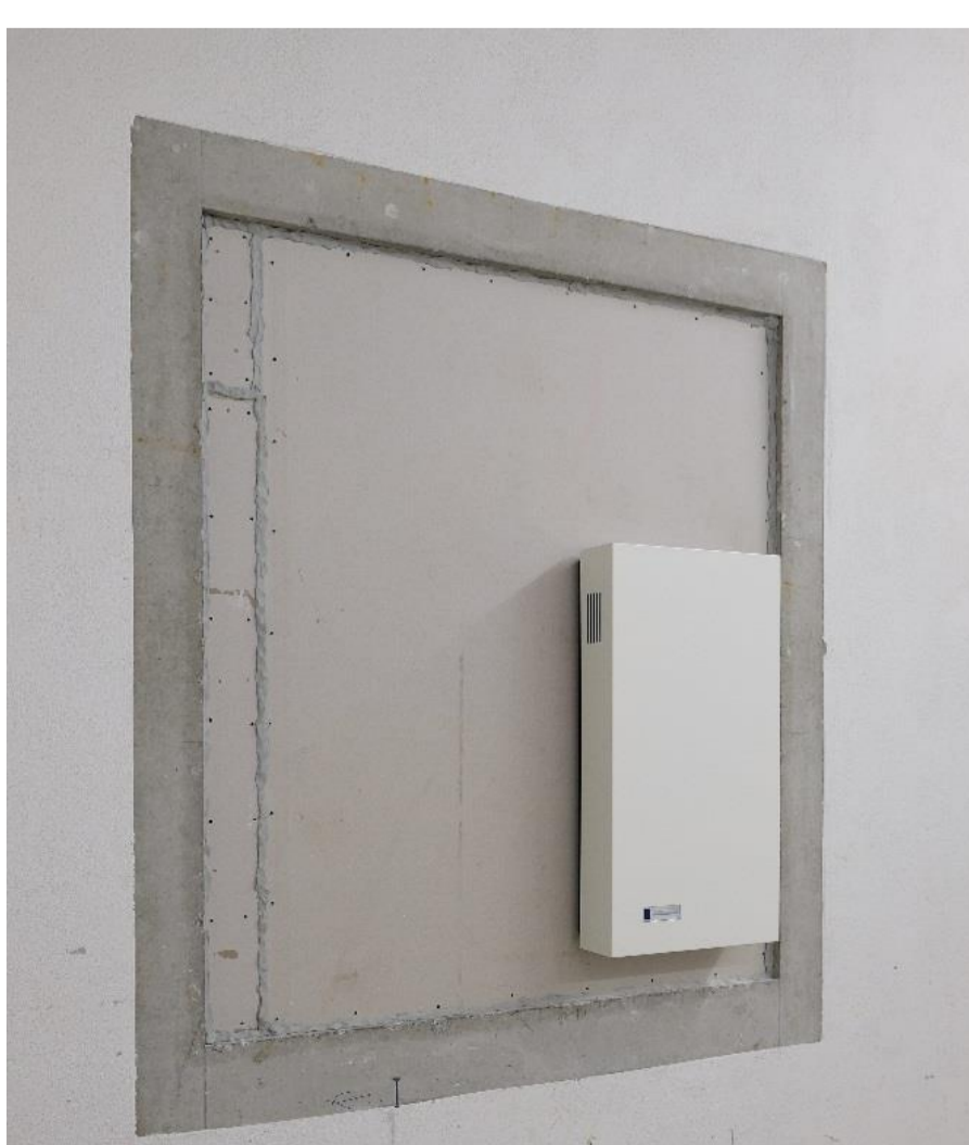
Messung der Schalleistung und der Schalldämmung eines dezentralen Lüftungsgeräts im Fensterprüfstand
