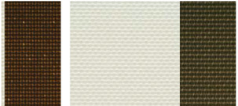
Abbildung C14: Beispiel Glasfasergewebe, links PTFE-beschichtet und rechts silikonbeschichtet
