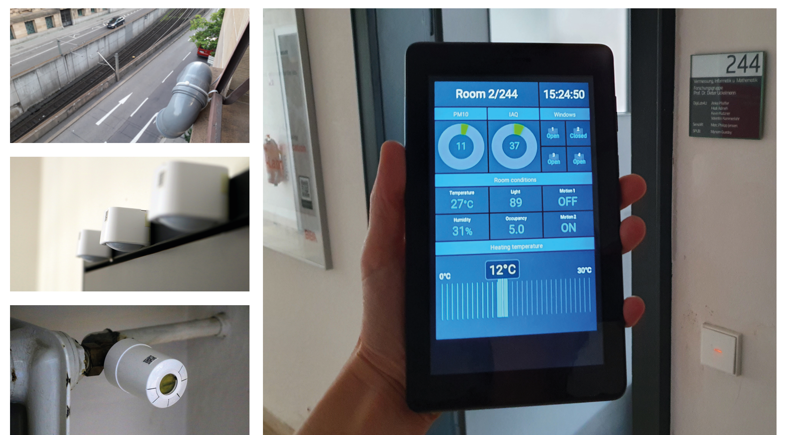
Abb. 3: Feinstaubsensor, Multisensor und smartes Thermostat; User Interface (basierend auf dem HABpanel von openHAB) zur Darstellung und Steuerung der Geräte auf einem Tablet.
