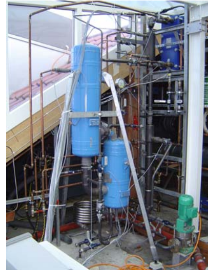
Abb.1: Zweiter Prototyp der DAKM kleiner Leistung.
