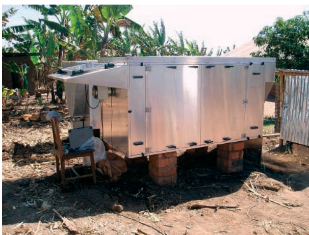
Abb. 1: Aufgebauter Solarvent 200 E als reiner Solartrockner mit PV-System. Foto HfT Stuttgart
