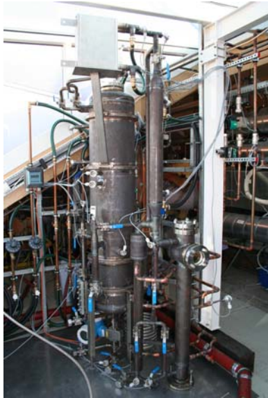
Abb.1: Dritter Prototyp der DAKM im Solarlabor des zafh.net an der HfT Stuttgart.
