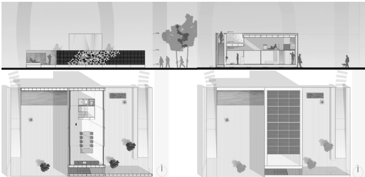
Abb. 2.4.1: Architektonisches Konzept mit integrierter Photovoltaik in Fassade und Dach
