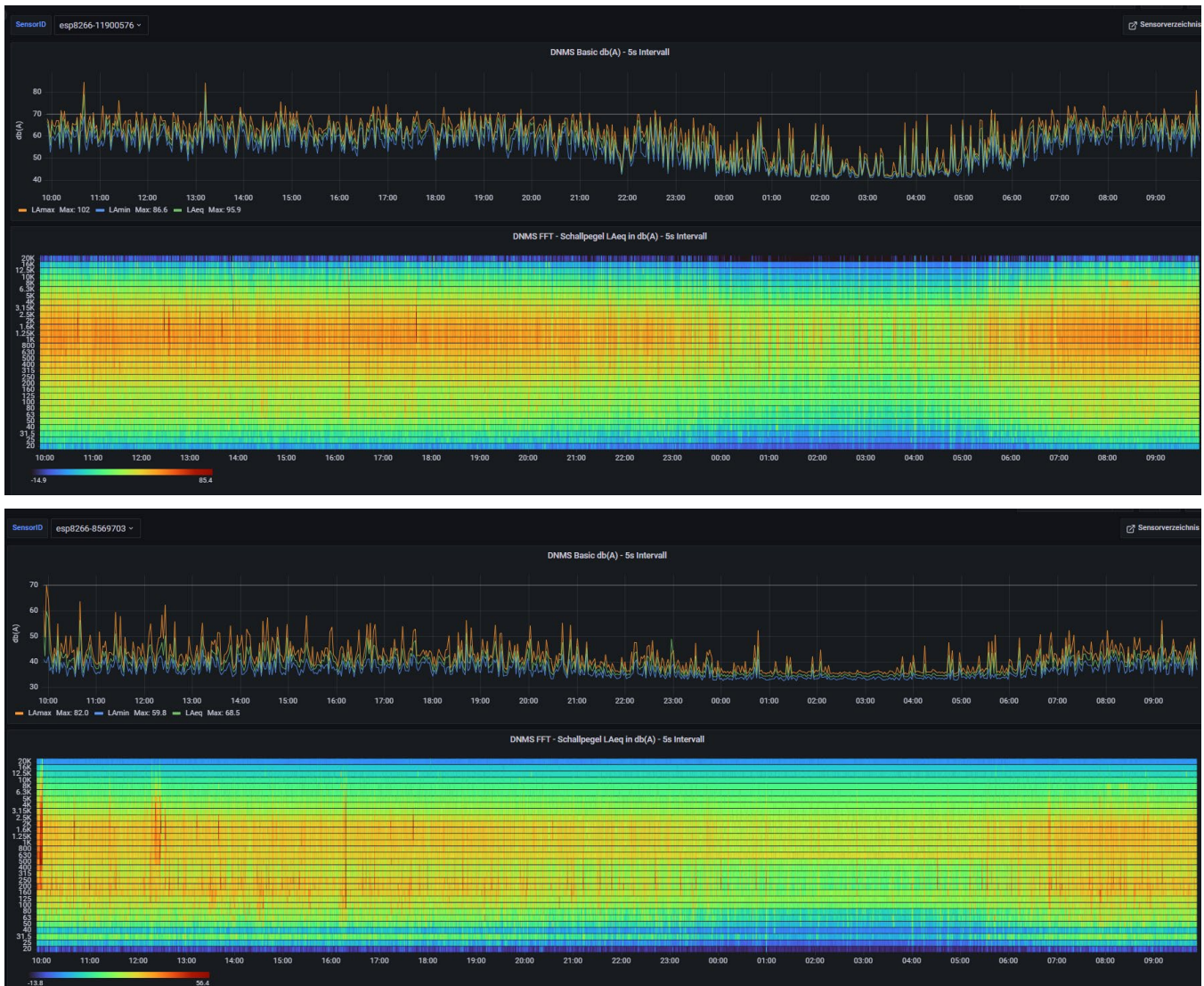
Abbildung 3: Am 05. und 06.02.2024 gemessene Außenpegel (Bild oben) und Pegel im Innenraum (Bild unten). Die A-bewertete Schalldruckpegel (Max. Min und Leq Werte) sind jeweils oben dargestellt, das zugehörige Spektrogramm dieser Werte ist darunter (Bitte unterschiedliche Skalierung beachten).
