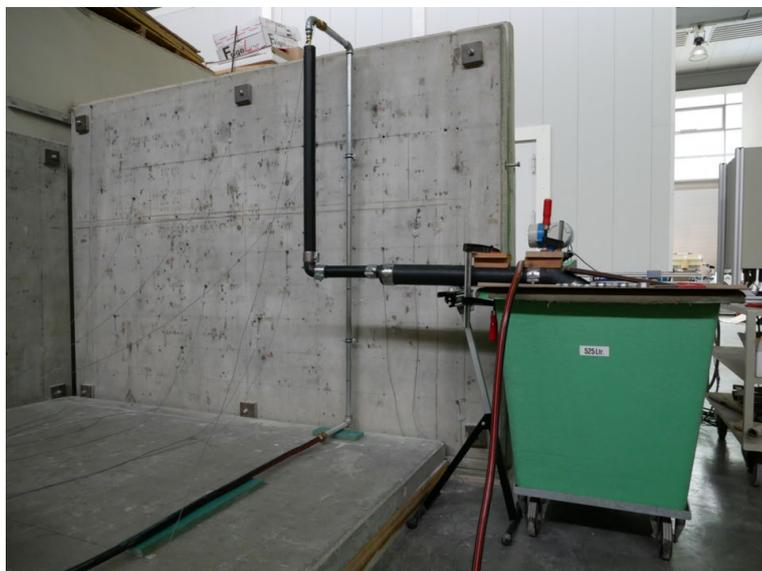
Abbildung 34: An einer Empfangsplatte montierte Trinkwasserleitung
