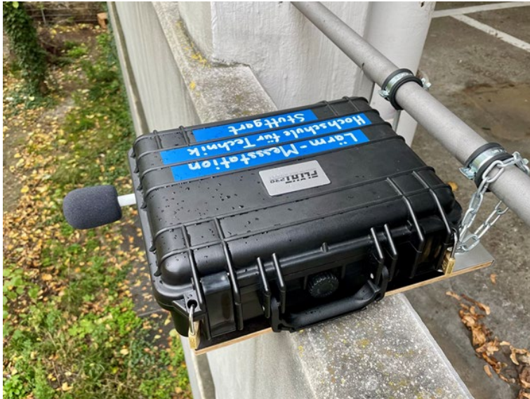
Abbildung 21: Lärmsensor im Schutzgehäuse mit mobilem WLAN-Router und Stromversorgung über zwei Powerbank-Akkus an der Parkhaus-Brüstung (Eigene Aufnahme)
