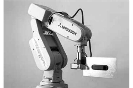
Der Roboterarm ist dafür verantwortlich, die RFID-Transponder zu wechseln.
