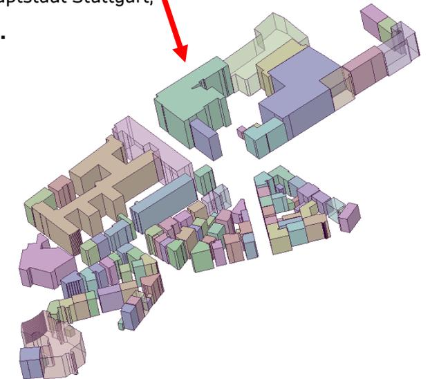
Modellerstellung: Das Luftvolumen um die Gebäude muss vernetzt werden
